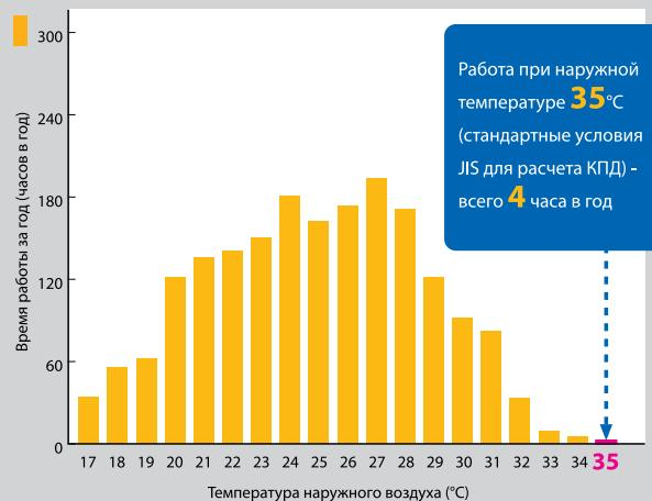
Работа при наружной температуре **35°C**
