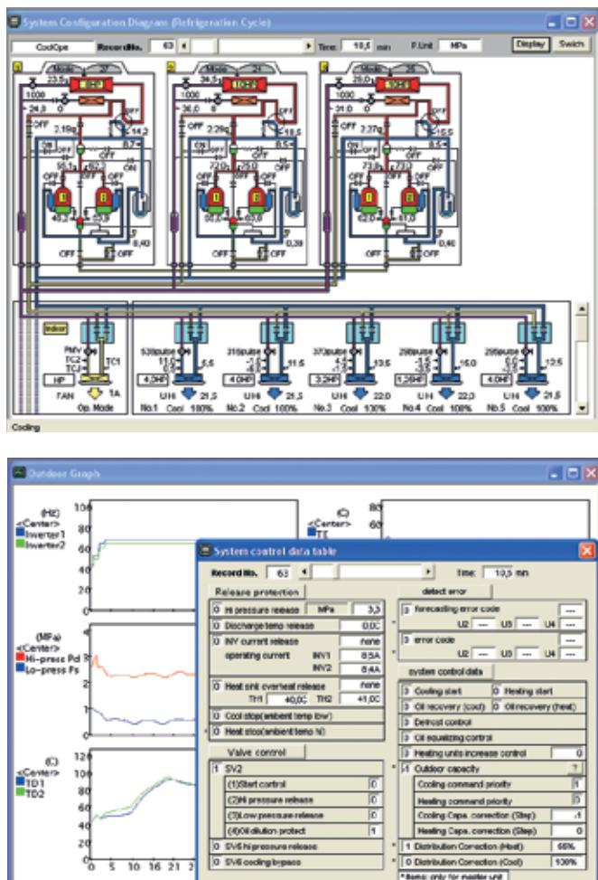
Интерфейс программы в графическом режиме позволяет наблюдать за работой в одном из двух различных окон с динамически меняющимися изображениями состояния и параметрами узлов, в зависимости от предпочтений, или в окне в виде таблицы всех параметров внешних и внутренних блоков системы.
