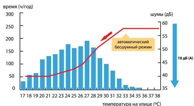
Шум наружных блоков зависит от двух факторов: скорости вращения движущихся компонентов, а также их конструкции и использованных материалов. Новое инверторное управление двигателем вентилятора позволило снизить его скорость до всего лишь 60 об/мин. Кожухи компрессоров и корпуса наружных блоков сконструированы так, чтобы максимально поглощать шум компрессоров.
