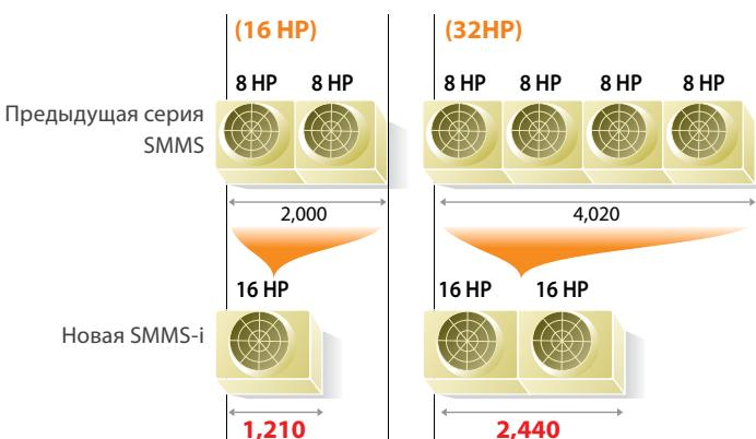
У системы SMMS-i 16HP габариты и масса наружного блока составляют всего 2/3 от параметров предыдущей системы.
