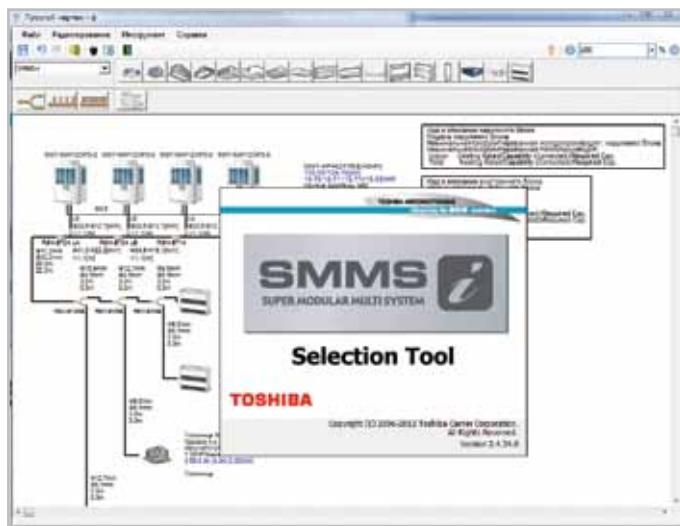
При выборе внутренних блоков учитываются требуемые холода- и теплопроизводительности, расчетные температуры воздуха в помещении, перепад высот и расстояние от последнего компонента. При изменении скорости вентилятора сразу можно увидеть изменения уровня шума и производительности.
